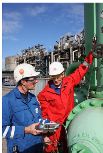
Misura di energia termica in raffineria: condotte di acqua di raffreddamento e portate di olio.
