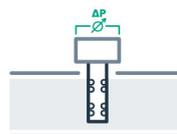
In base principio Bernoulli è possibile determinare la velocità di transito del fluido tramite la differenza tra la pressione dinamica rilevata a monte di un elemento inserito nella tubazione e la pressione statica misurata a valle dell'elemento stesso.
